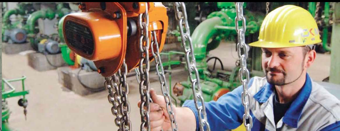
CB 手拉葫芦 500kg - 10t 额定载荷
